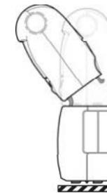
Um die Steuereinheit mit der Traverseneinheit zu verbinden, setzen Sie die Steuereinheit wie abgebildet auf und kippen Sie sie, bis der Riegel einschnappt.
