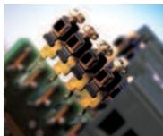
Zugänglichkeit und Sicherheit: groß dimensionierte Anschlussklemmen, galvanisch getrennte Kanäle
