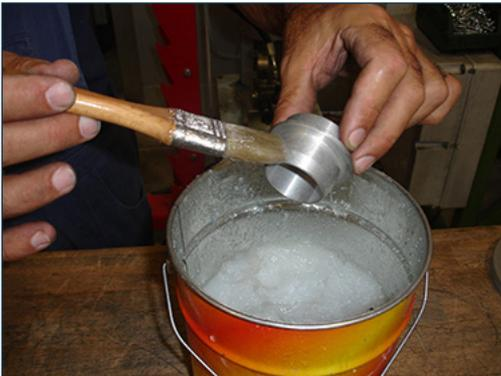
5) Lubrificare la parte esterna delle boccole utilizzando solo grasso a base siliconica.
